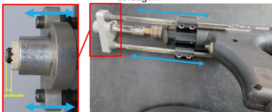
Figura 5 – Representação da regulagem do parâmetro protrusão na pistola de soldagem
