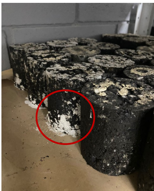
Figura 6.4 - Névoa branca formada sobre as amostras condicionadas em água no ensaio de Duriez.
