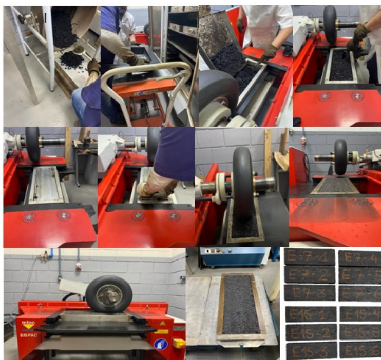
Figura 5.26 - Compactação das placas para o ensaio de deformação permanente.
