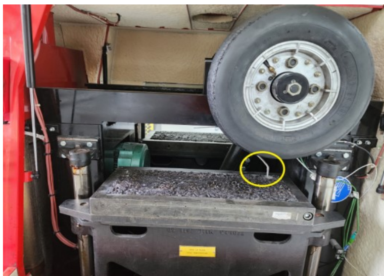
Figura 5.28 - Placa posicionada na máquina com a sonda de monitoramento de temperatura.
