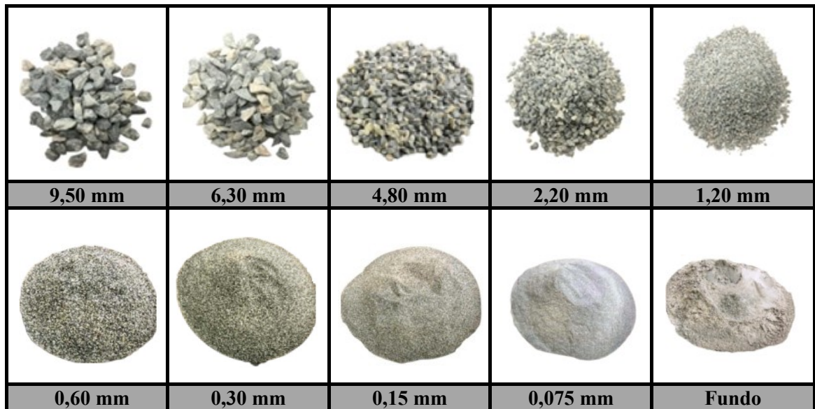
Figura 5.3 - Frações granulares utilizadas na formulação das misturas asfálticas de referência.
