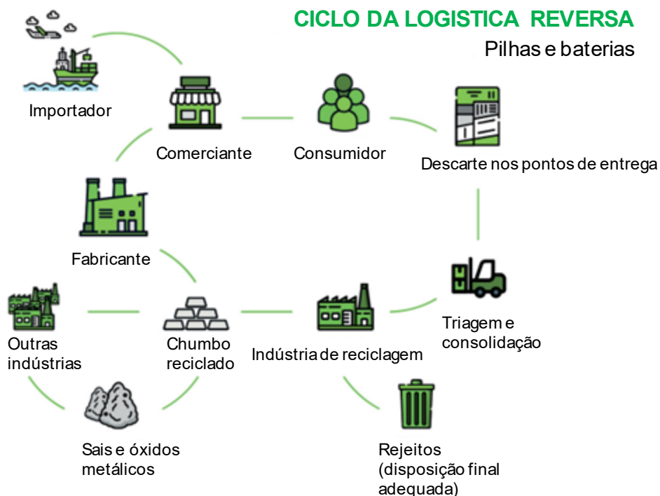
Figura 3.5 - Ciclo do sistema de logística reversa de pilhas e baterias.
