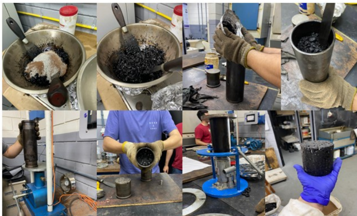
Figura 5.21 - Procedimentos de mistura, moldagem por compactação a duplo pistão, e extração dos corpos de prova.
