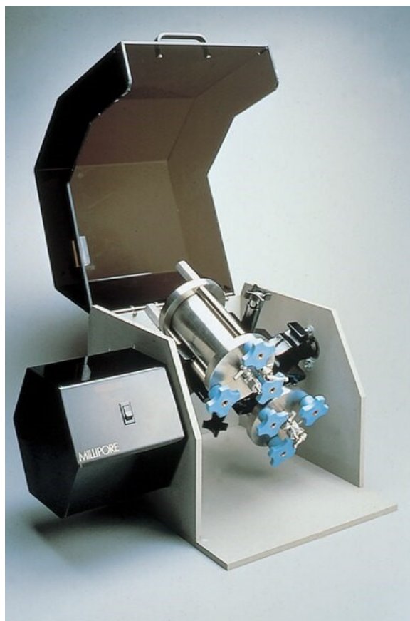
Figura 5.24 - Agitador rotativo utilizado no ensaio de lixiviação.
