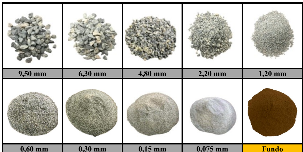
Figura 5.4 - Frações granulares com incorporação de 7,0 % de escória de chumbo-ácido.
