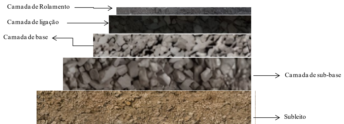
Figura 2.1 - Estrutura de pavimento de concreto asfáltico.
