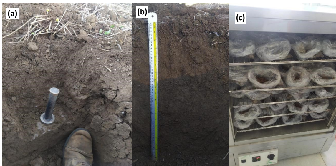
Figura 6. Coleta de solos estratificada até 40cm de profundidade (a) trincheira para coleta de solo (b) secagem em estufa a 40°C (c)
