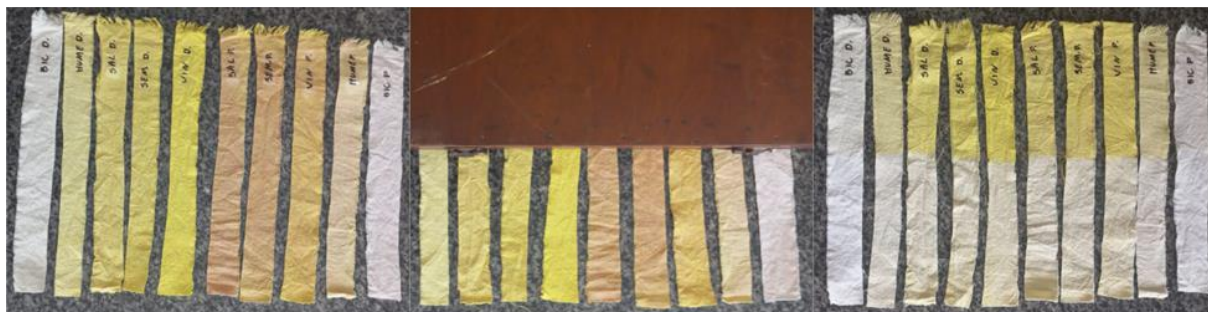
Figura 4: Teste de resistência à luz. Fonte: elaborado pelos autores.
