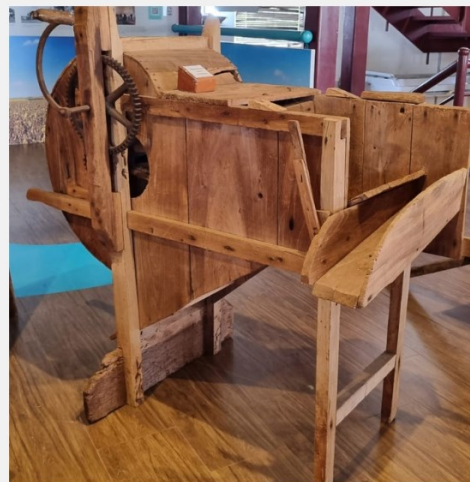
Fonte: da autora (2023), Imagem 4, descascador de grãos.
