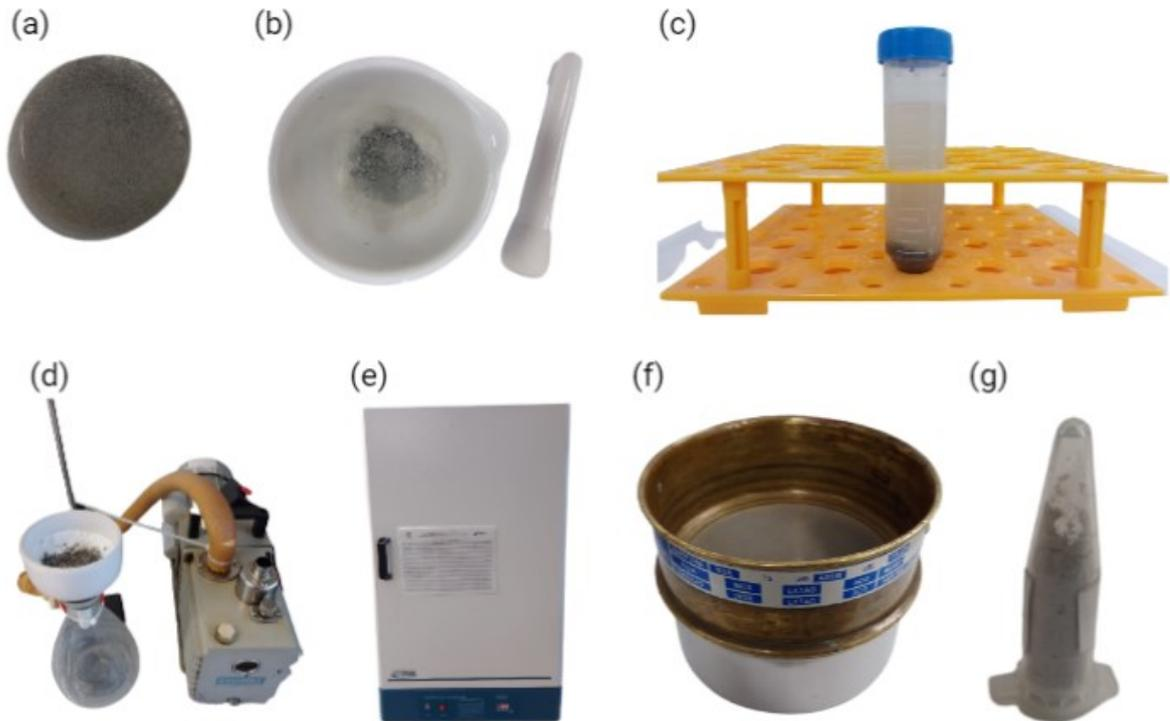
Legenda: (a) amostra; (b) Moagem manual em almofariz; (c) Repouso por 72 horas em solução com álcool isopropílico; (d) Bomba de vácuo; (e) Estufa à 40°C até estabilização de massa; (f) Peneiramento da amostra em peneira de abertura #200; (g) Acondicionamento até ensaio.
