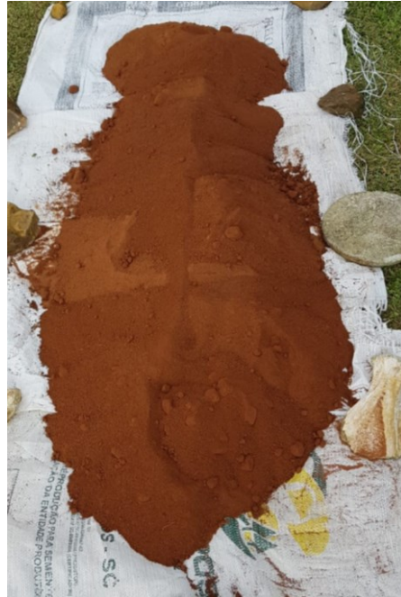
Figura 1 - Solo em cima da lona para aplicação de carbono de cálcio.
