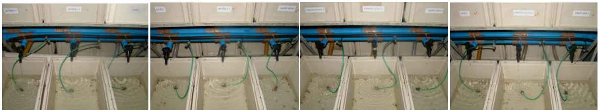
Figura 4. Tanques experimentais aerados em sistema de recirculação de água.
