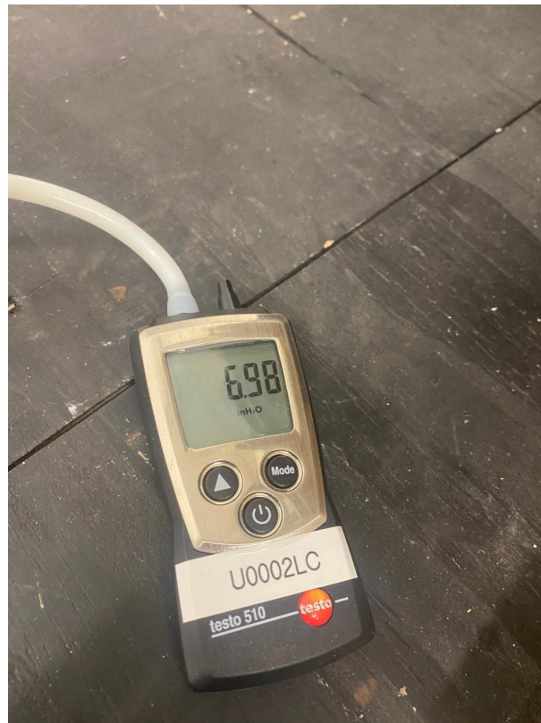
Figura 14 – Manômetro de saída.
