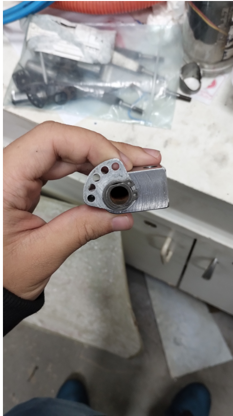
Figura 55 – Montagem da chapa de regulagem
