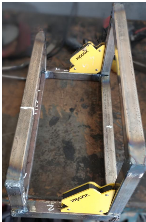
Figura 68 – Adição de tubos no quadro traseiro da bancada de teste
