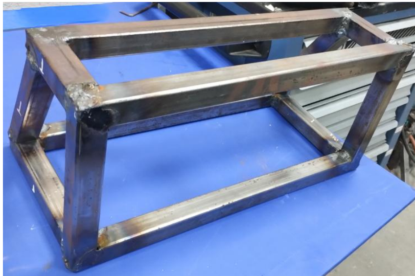
Figura 70 – Estrutura base bancada de teste - vista traseira
