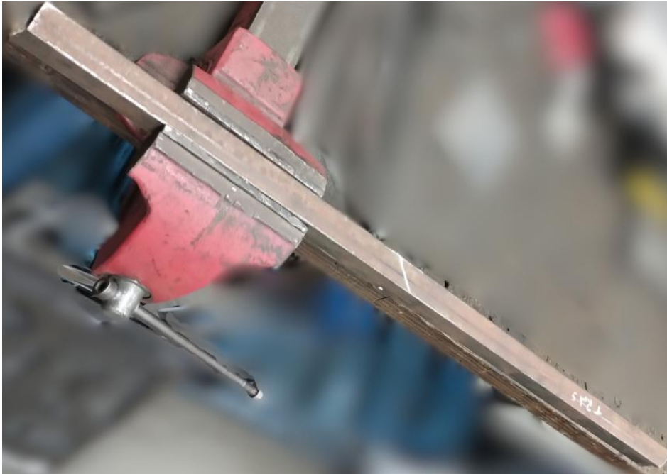
Figura 63 – Preparação para o corte dos tubos da bancada de teste
