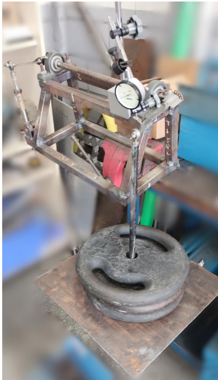
Figura 77 – Bancada de teste montada com carregamento das anilhas
