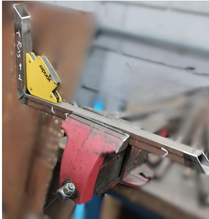
Figura 65 – Tubos posicionados na morsa
