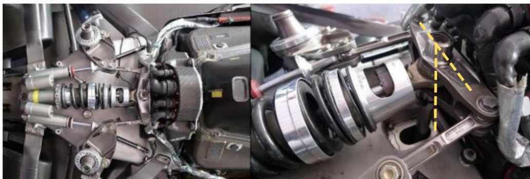
Figura 26 – Barra estabilizadora do tipo T traseira da Red Bull
