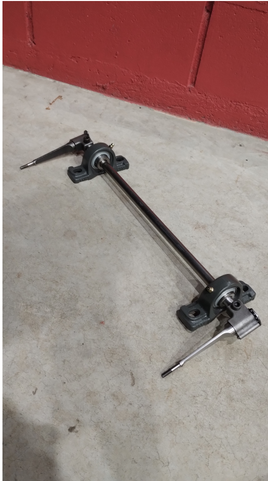
Figura 58 – Montagem da barra estabilizadora
