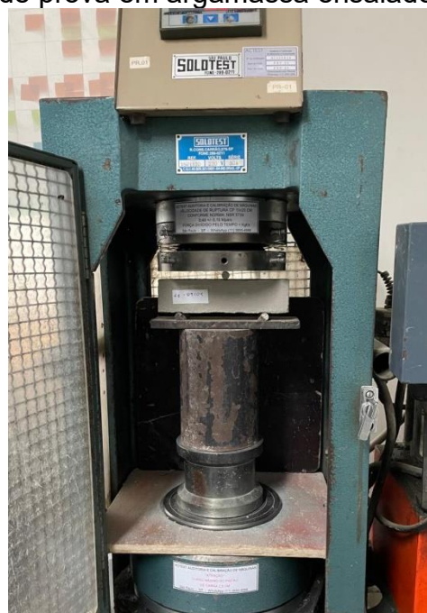
Figura 9 – Corpo de prova em argamassa ensaiado à tração na flexão
