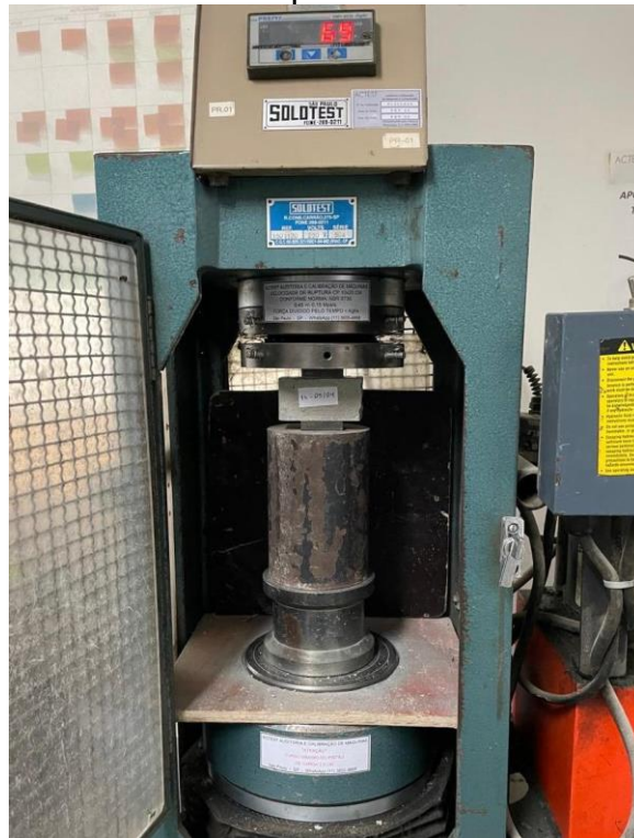
Figura 10 - Ensaio de resistência à compressão de uma das argamassas estudadas
