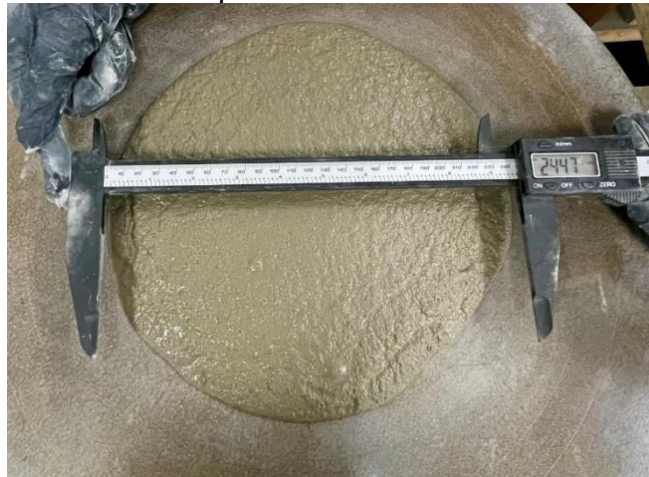
Figura 8 - Medição do diâmetro de abertura de uma das argamassas usadas no presente estudo
