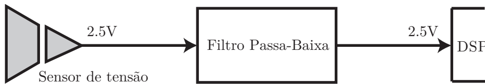
Figura 31 – Representação do bloco de condicionamento de tensão.
