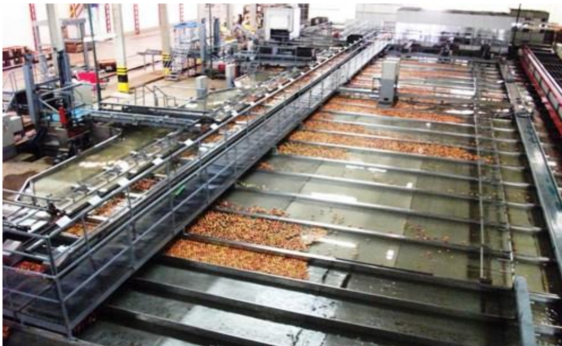
Figura 8. Vista superior da máquina de pré-classificação de frutos. Fonte: Gabriella Vanderlinde Fernandes, 2011.
