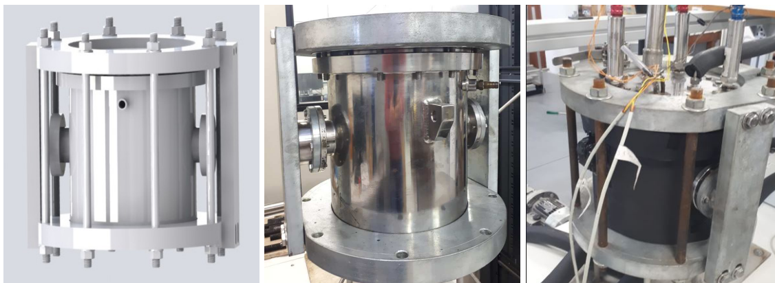
Figura 43 – Reservatório de fluido (tanque) de CO 2 .
