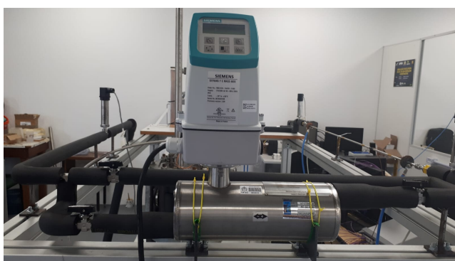
Figura 34 – Medidor de vazão mássica SIEMENS.
