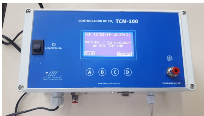
Figura 42 – Controlador/Medidor de CO 2 : TECNOPON.
