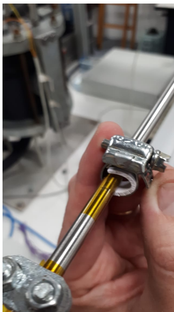
Figura 38 – Fixação do termopar na seção de teste 1.
