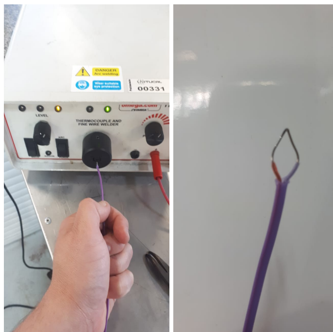
Figura 37 – Termopares do tipo E soldados por descarga capacitiva.
