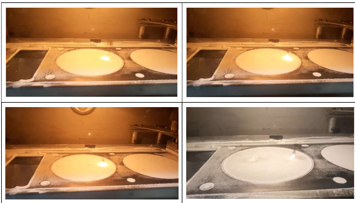
Figura 78 – Imagens de aparição de chama no leito no decorrer da fabricação
