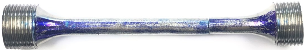
Figura 46: Corpos de Prova típicos para cada bloco unido por difusão após o ensaio de tração uniaxial. Bloco A (a), Bloco B (b) e Bloco C (c).
