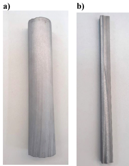
Figura 18: Corpos de prova retirados dos blocos unidos por difusão. Corpo de prova para ensaio mecânico de tração (a) e corpo de prova para caracterização microestrutural (b).
