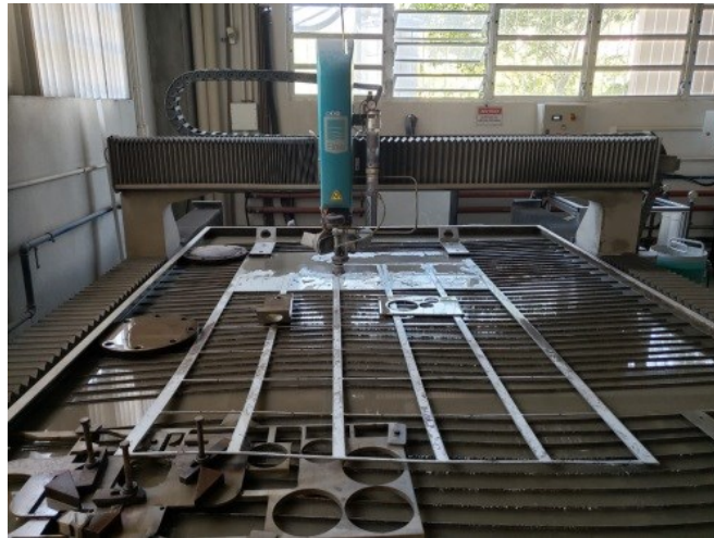
Figura 10: Corte, por jato d'água, das chapas, resultando em chapas menores de 210 mm por 210 mm.
