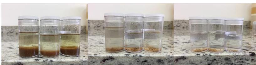
**Figura 7:** Amostras filtradas na peneira de 300 µm. Profundidades: 1 metro (esquerda), 8 metros (centro) e 13 metros (direita).
