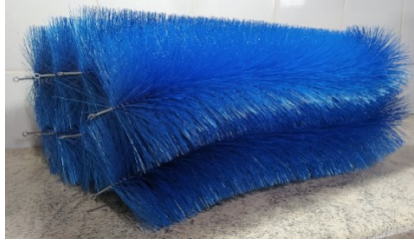
Figura 19: Escovas filtrantes utilizadas.
