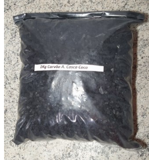
Figura 20: Carvão ativado utilizado.
