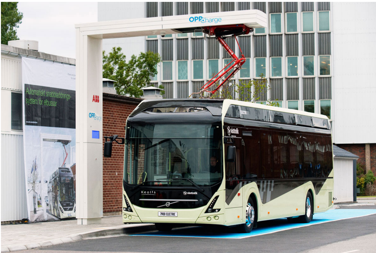
Figura 9 – Exemplo de carregamento condutivo na cidade de Gotemburgo, na Suécia.
