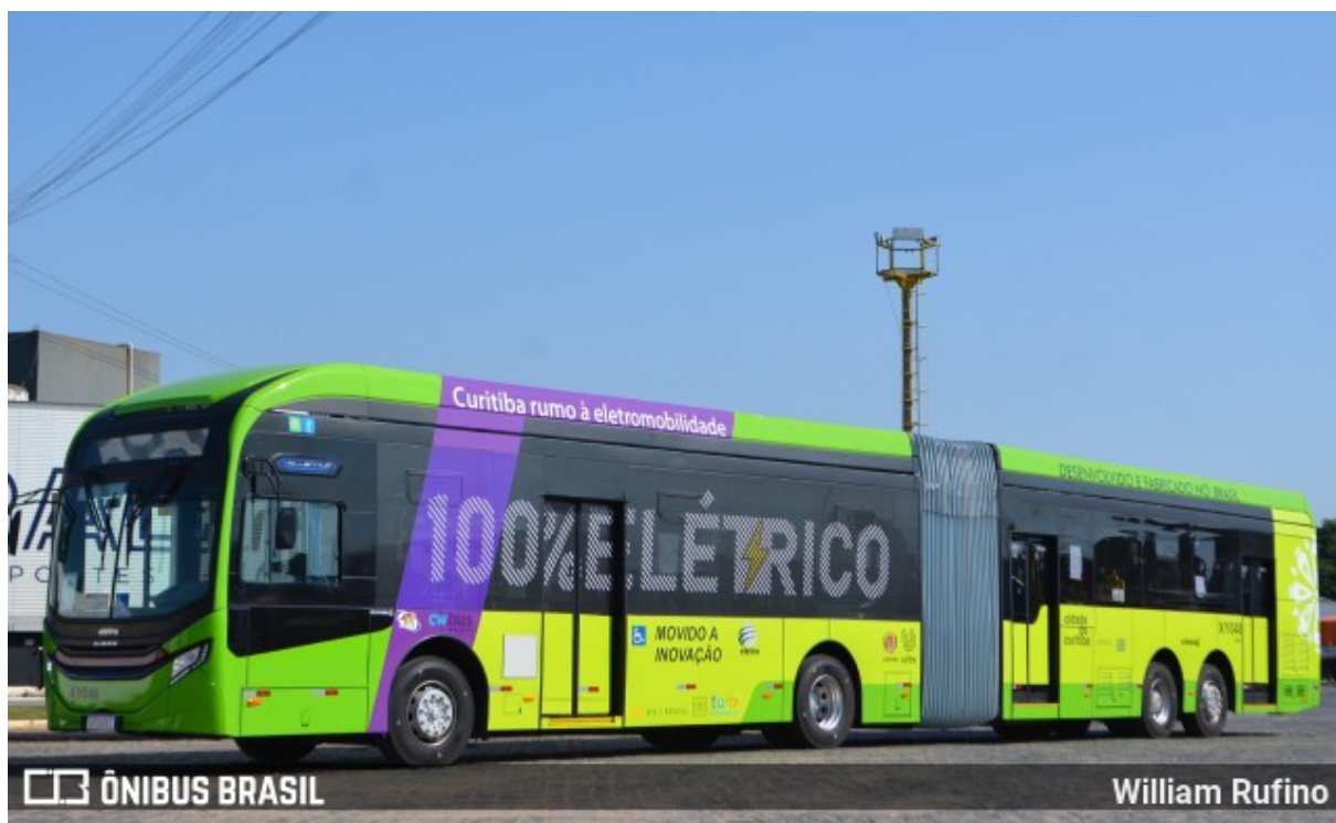
Figura 19 – Modelo E-Millennium o-500 UDA-ELETRA em testes em Curitiba, Paraná.
