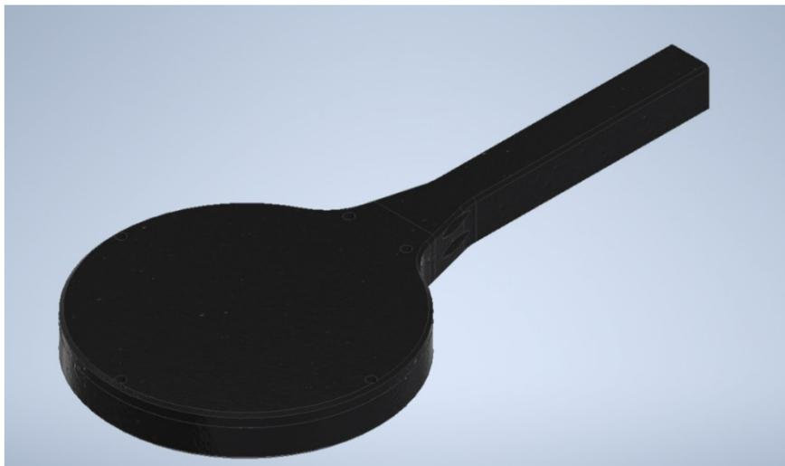
Figura 40 - Estrutura de suporte e encapsulamento da bobina de indução.
