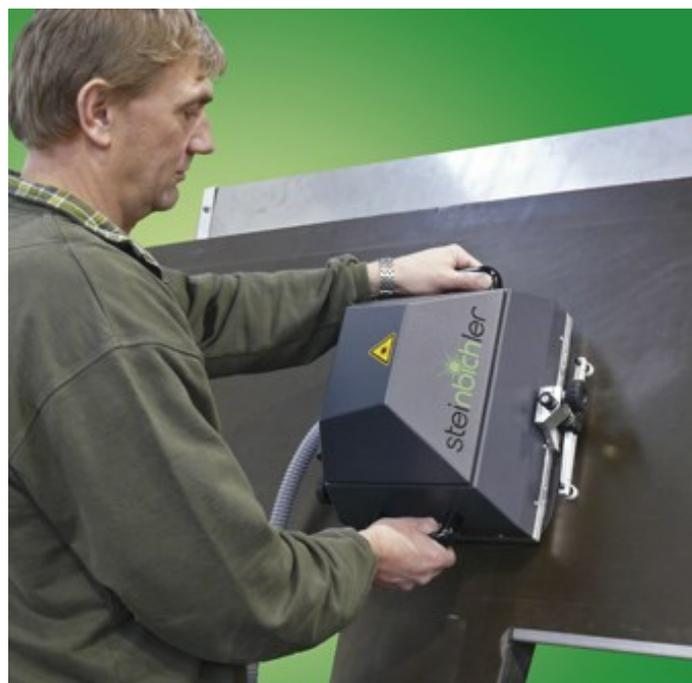
Figura 33 - Sistema de shearografia Steinbichler [36].
