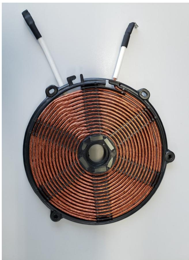
Figura 38 - Bobina de indução do fogão.
