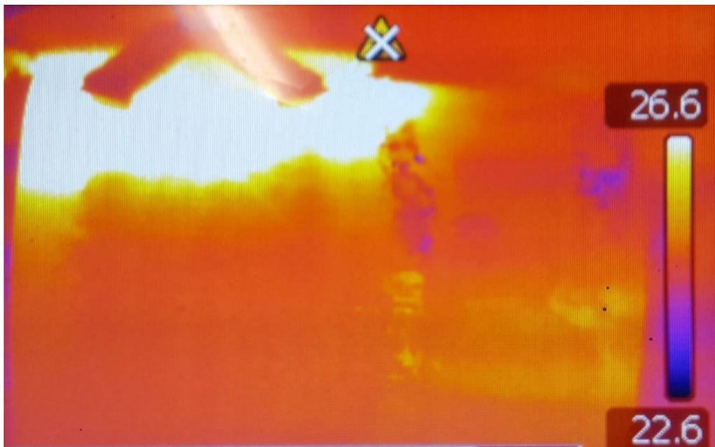
Figura 39 – Imagem termográfica da bobina de indução aquecendo um CP.
