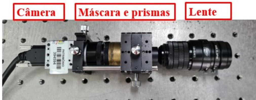
Figura 45 - Montagem experimental do cabeçote one-shot.
