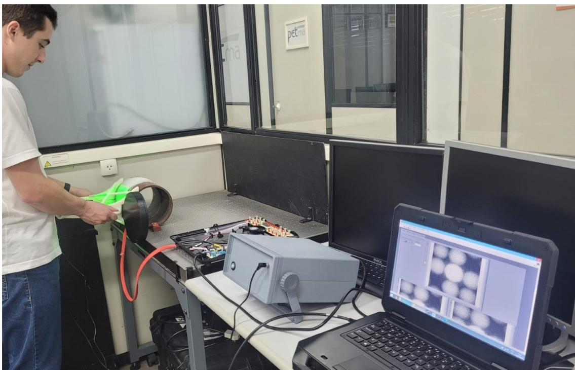
Figura 62 - Protótipo em inspeção com fixação manual.
