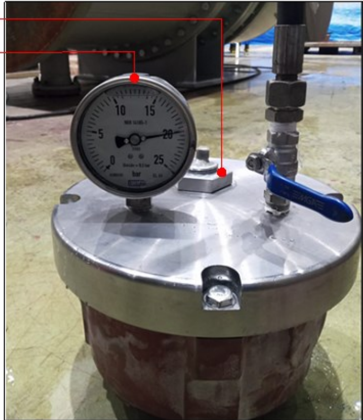
Figura 15 - Pressurização do aparato experimental
