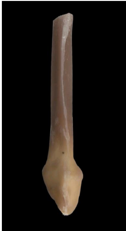
Figura 4 - Fotografia de fíbula compósita de quarta geração - Extremidade distal de fíbula esquerda
