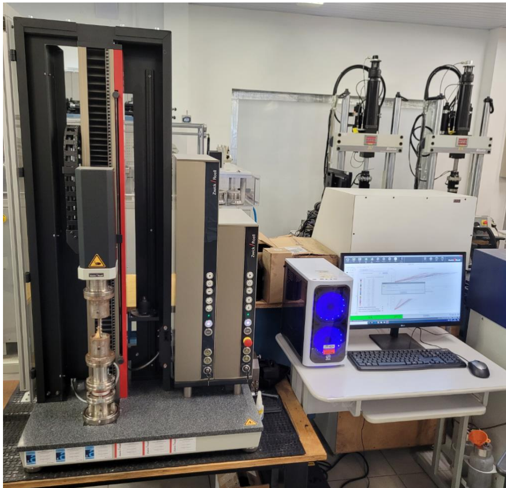
Figura 12 - Máquina de ensaios universal - Zwick/Roell modelo Z2.5
