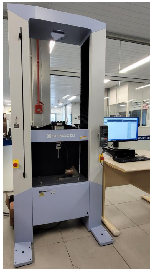
Figura 13 - Máquina de ensaios universal servoelétrica – Shimadzu AGS-X 100kN
