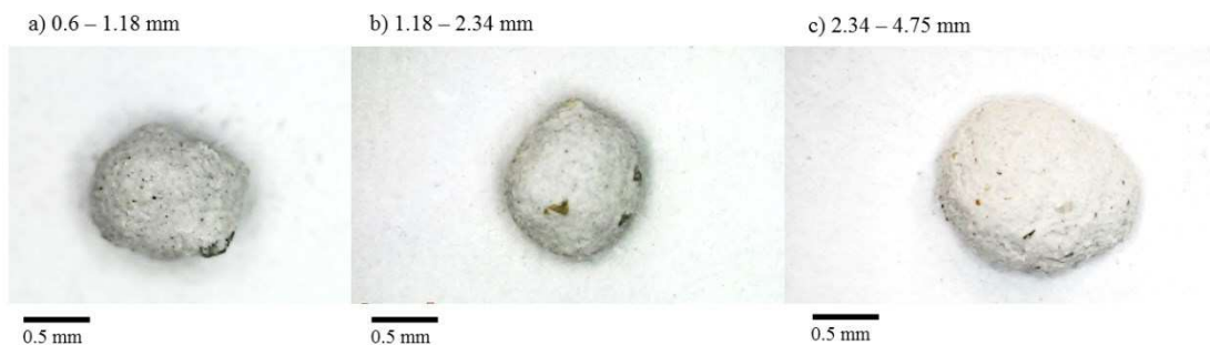
Figura 43- Aparência dos pellets (S, M e L) constituídos de CAC-FGD (60% - 35%) após a sua síntese
