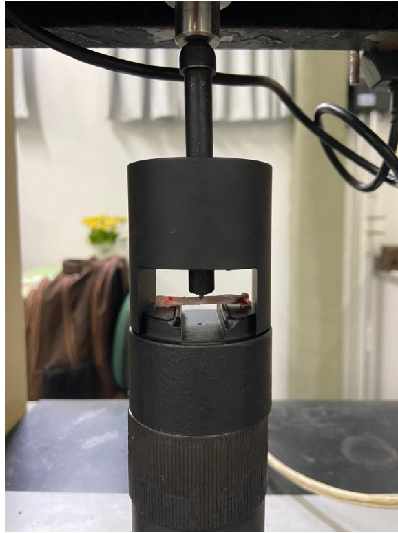
Figura 6 - Imagem da máquina de ensaio mecânico de flexão de três pontos.
