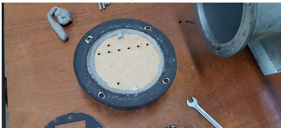
Figura 87 – Detalhamento do porta-amostra com massa de calafetar vedando as frestas.
