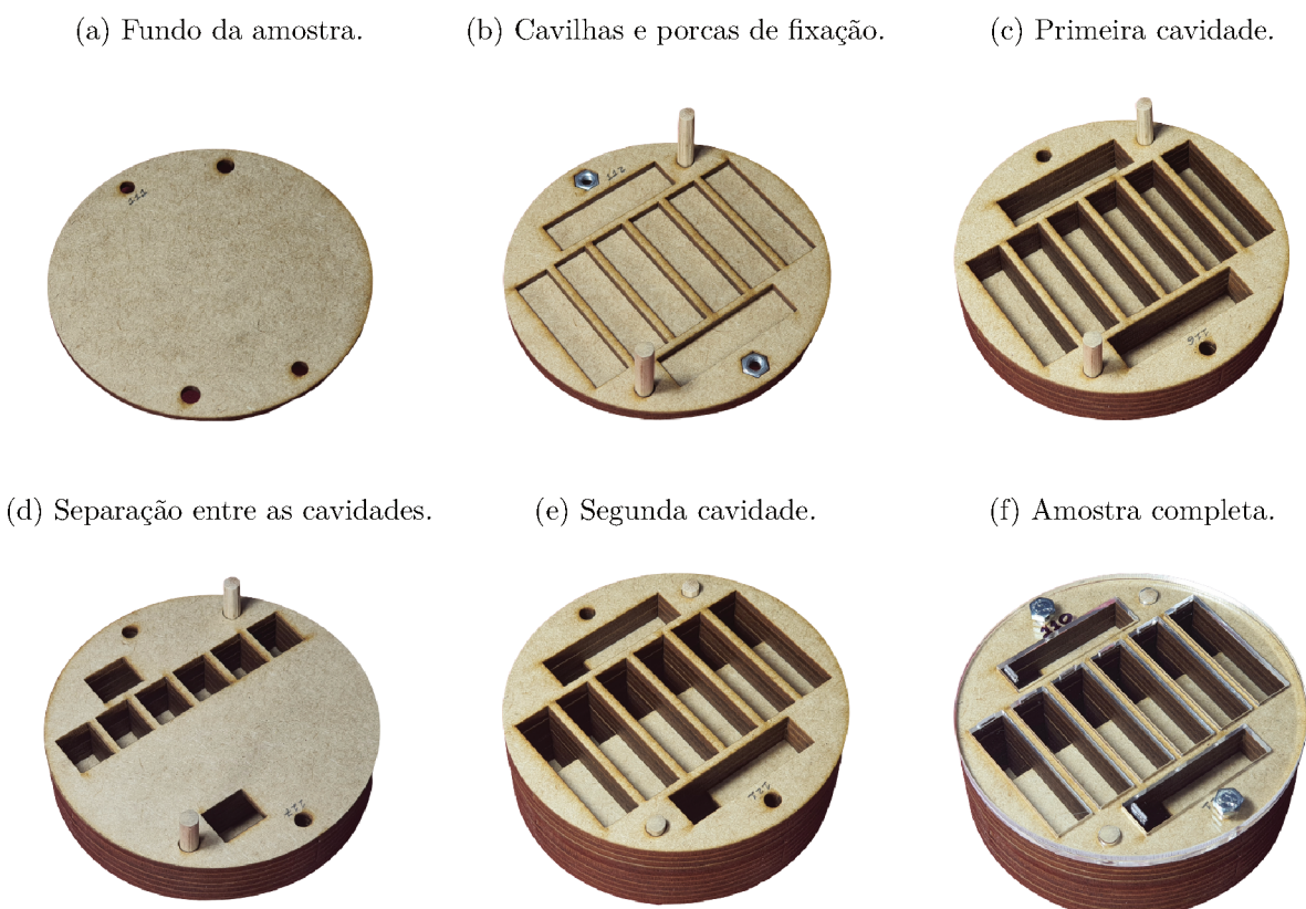
Figura 33 – Processo de montagem de amostras de espaço enrolado, n=2 em MDF.
