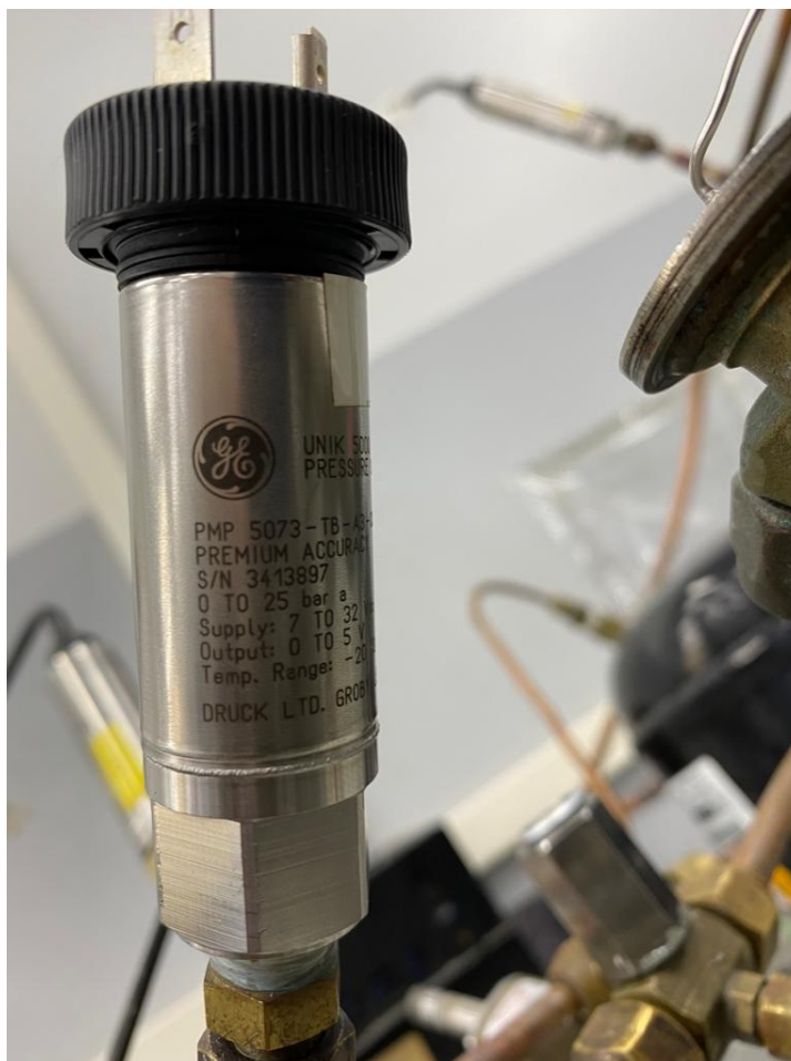
Figura 26 – Transdutor de pressão UNIK PMP 5073 instalado na bancada
