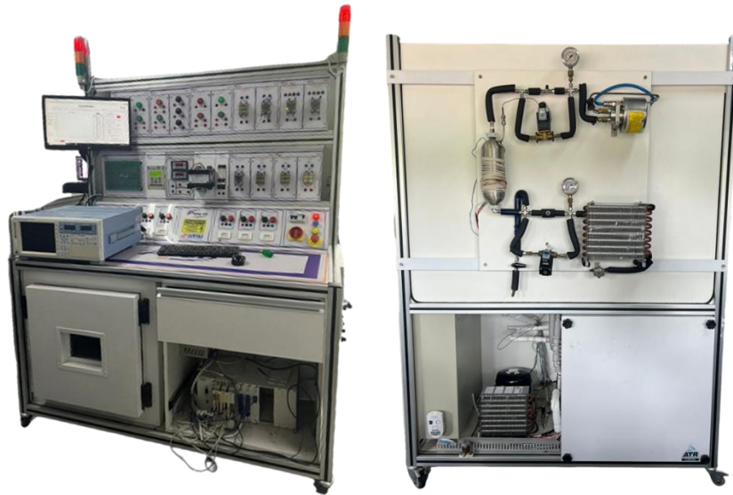
Figura 3 - Vista frontal (esquerda) e vista traseira (direita) do calorímetro.
