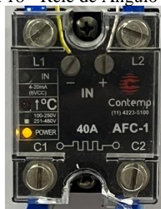
Figura 18 - Relé de Ângulo de Fase.
