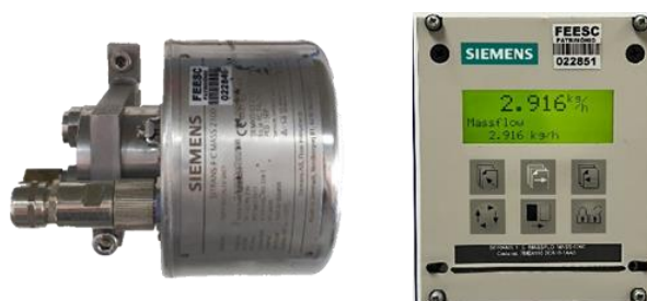
Figura 15 – Transdutor de vazão mássica (esquerda) e unidade de tratamento de sinal (direita).
