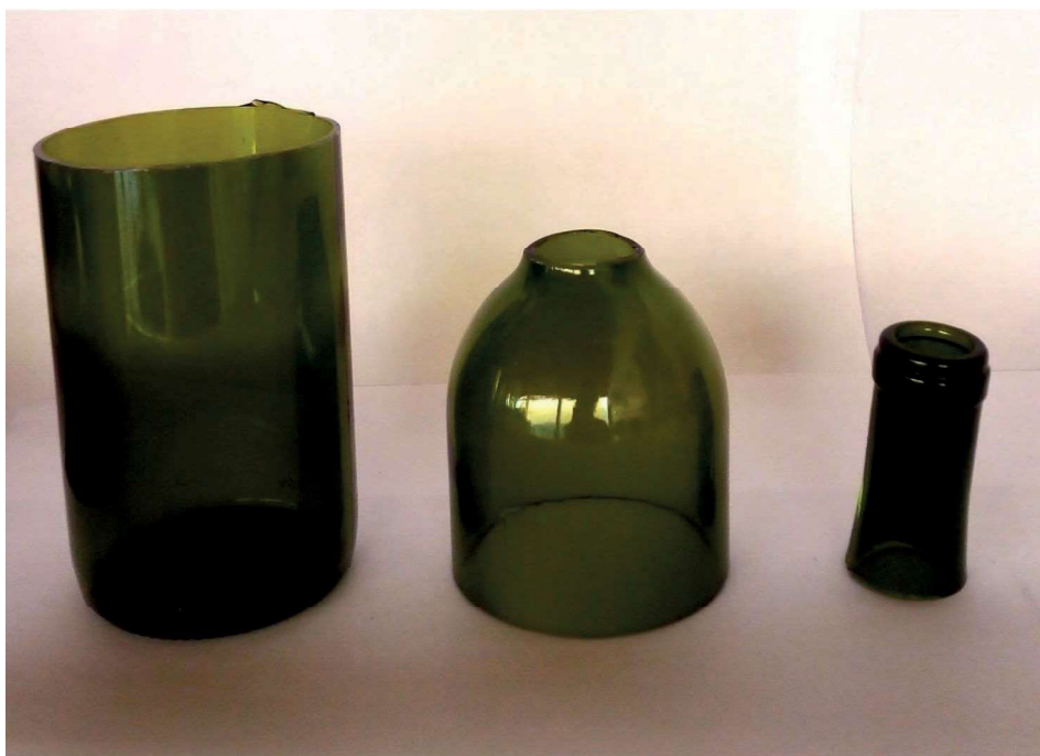
Figura 5 - A partir de dois cortes, a garrafa pôde ser dividida gerando três peças.
