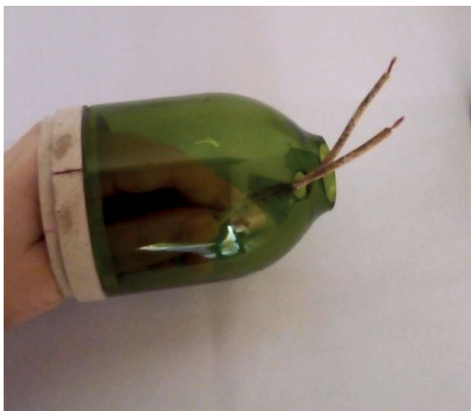
Figuras 14 e 15 - Furo por onde passa a fiação e encaixe do suporte para soquete. Fonte: da autora, 2020
