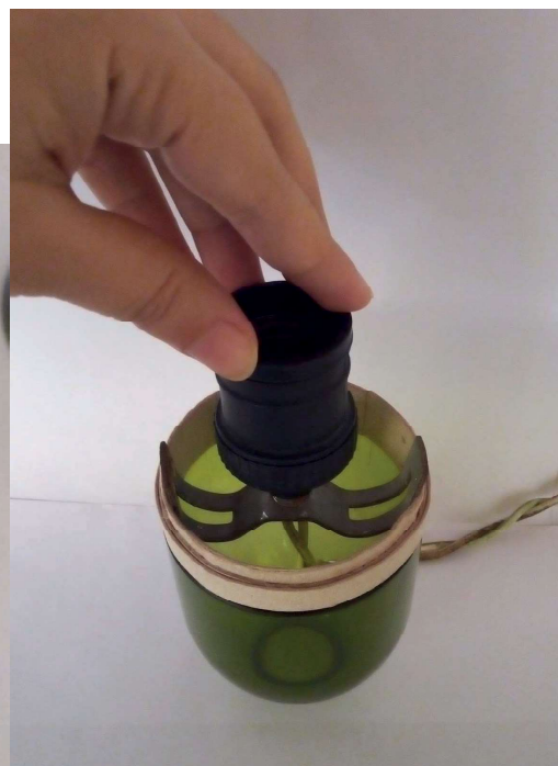
Figuras 14 e 15 - Furo por onde passa a fiação e encaixe do suporte para soquete. Fonte: da autora, 2020
