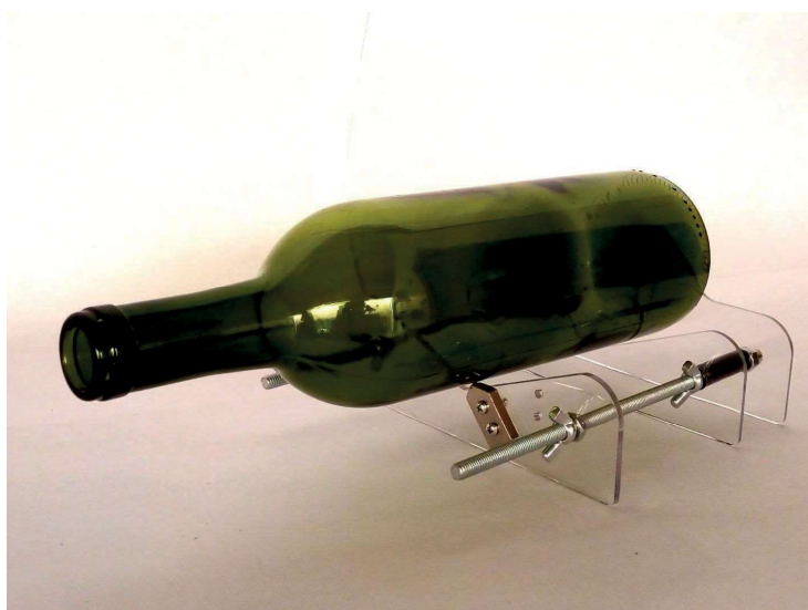
Figura 1 - A garrafa é posicionada no cortador com a distância exata que será cortada. Fonte: da autora, 2020
