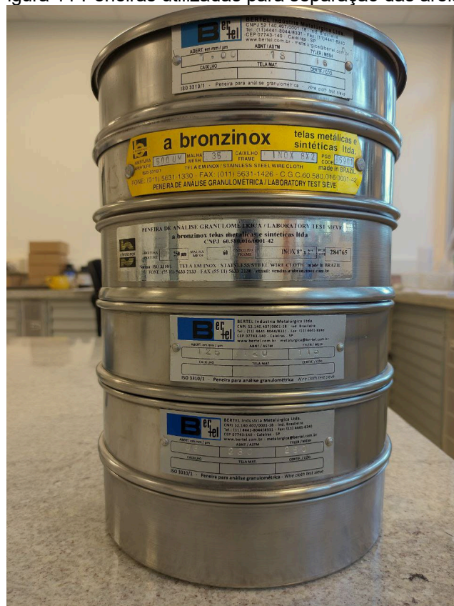
Figura 11 Peneiras utilizadas para separação das areias
