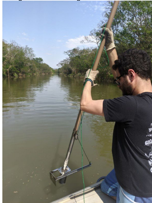
Figura 27 Amostragem de sedimentos
