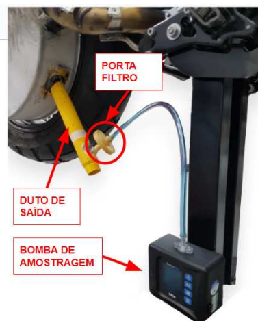
Figura 24 – Montagem final do duto de saída e amostragem
