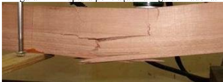
Figura 11 – Ruptura por tração na viga de madeira.
