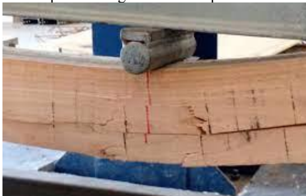
Figura 9 – Ruptura da viga de madeira proveniente da flexão.
