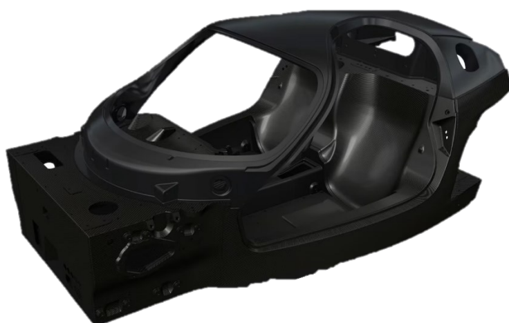
Figura 8 – Monocoque em fibra de carbono (Ferrari F70)
