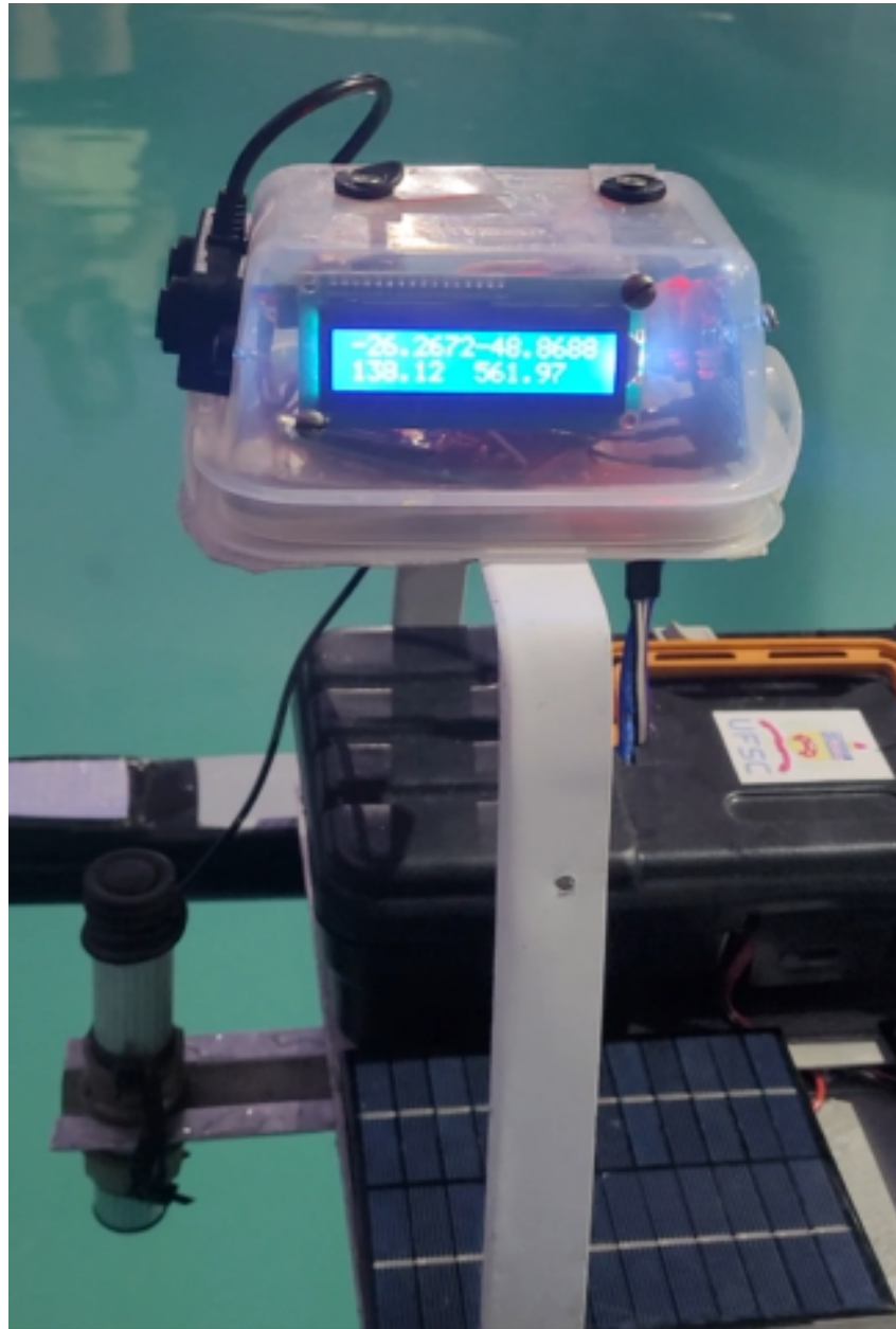
Figura 33 – Leitura de coordenadas geográficas, profundidade e distância frontal
