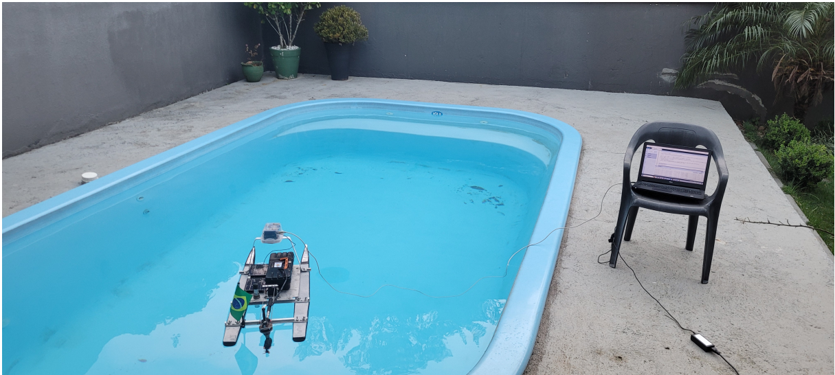
Figura 32 – Teste do protótipo USV em piscina
