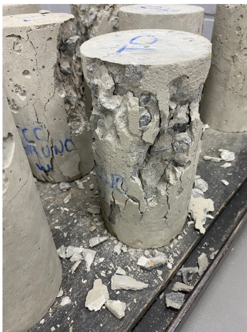
Figura 10 - Corpos de prova rompidos
