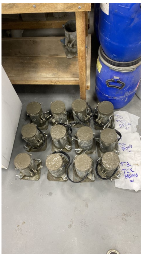
Figura 7 - Corpos de prova em estado fresco
