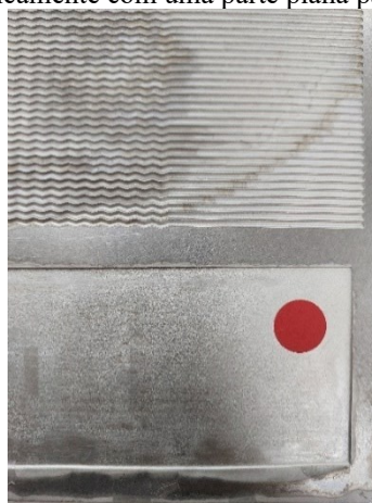
Figura 37 - Chapa usinada fotoquimicamente com uma parte plana para análise do fundo do canal.
