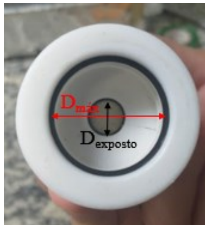
Figura 48 - Célula eletroquímica em (a) e Porta amostra D_{máx}=25\text{mm} e D_{exposto}=14\text{mm} em (b).
