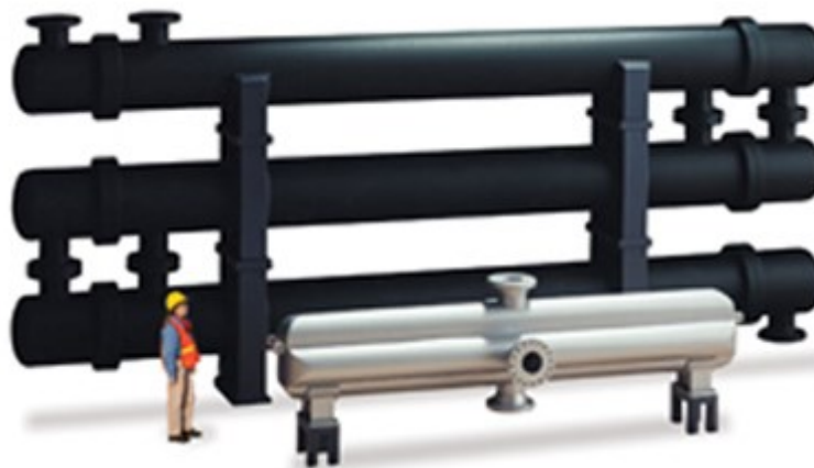
Figura 1 - Esquema do trocador tipo casco tubo em relação ao trocador de calor compacto (PCHE).
