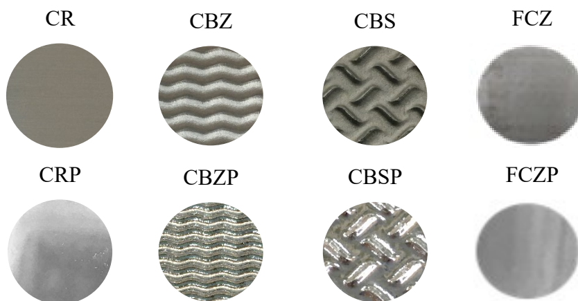
Figura 49 - Exemplo das amostras usadas para ensaio de corrosão nas 8 condições avaliadas.
