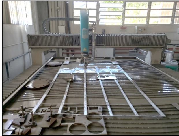
Figura 32 - Máquina de corte via jato d'agua presente no Labtucal.
