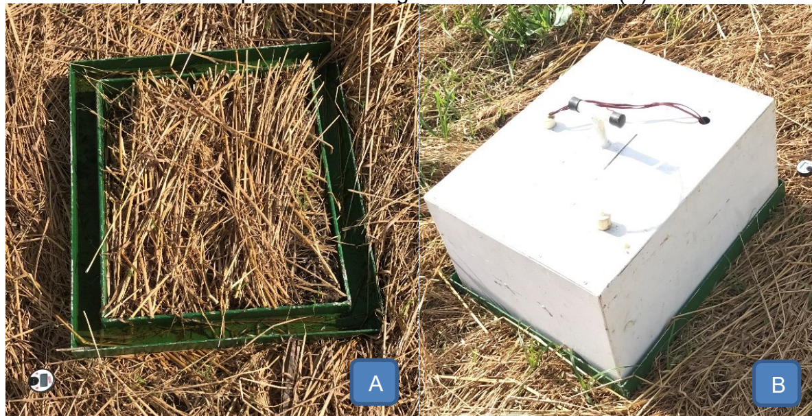
Figura 4 - Base de metal fixada no solo (A) e modelo de câmara estática que será utilizada no experimento para coleta dos gases de efeito estufa (B).
