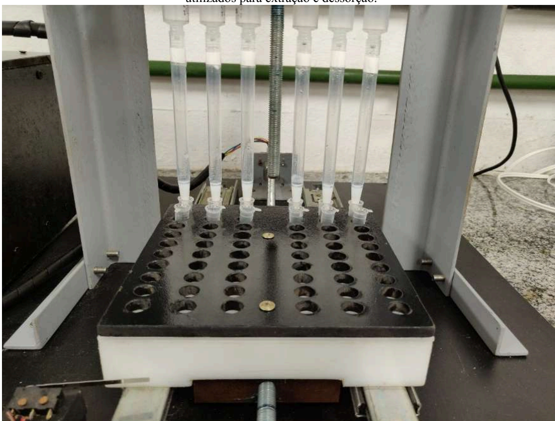
Figura 28. Novo porta amostra (em preto) sobre a placa inicial (PEAD, em branco) e frascos de PP utilizados para extração e dessorção.
