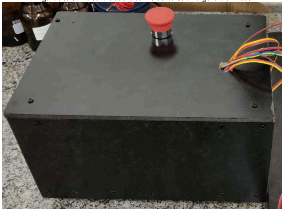
Figura 30. Caixa controladora com o botão de emergência em foco
