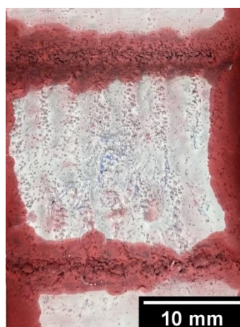
Figura 57. Resultado do ensaio com líquido penetrante obtido com a condição TI13013-14
