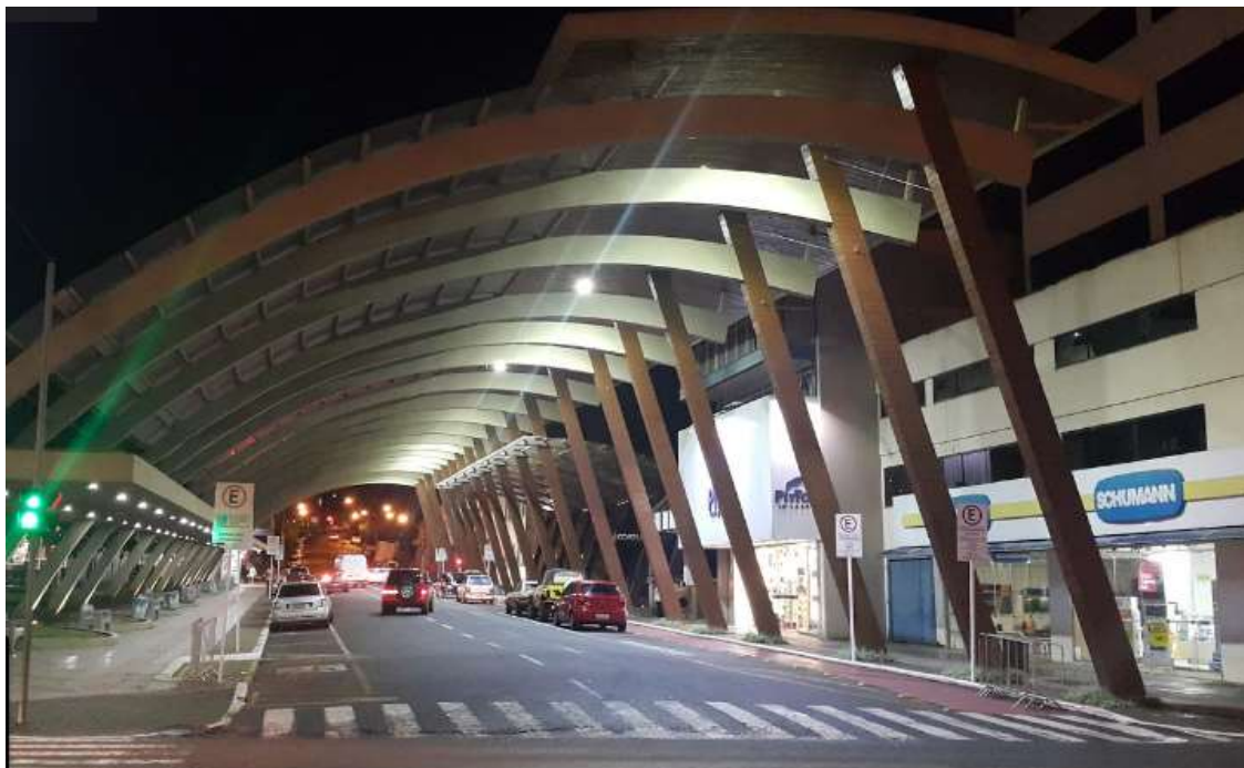
Figura 2: Comparativo entre a luz com lâmpada de vapor de sódio (no final da via) e vapor de mercúrio (na rua central). Fonte: Autores, 2018.
