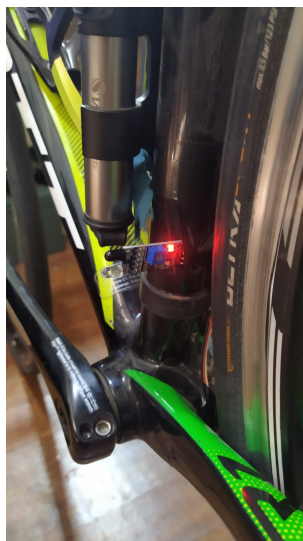
Figura 19 – Sensor infravermelho instalado na bicicleta.
