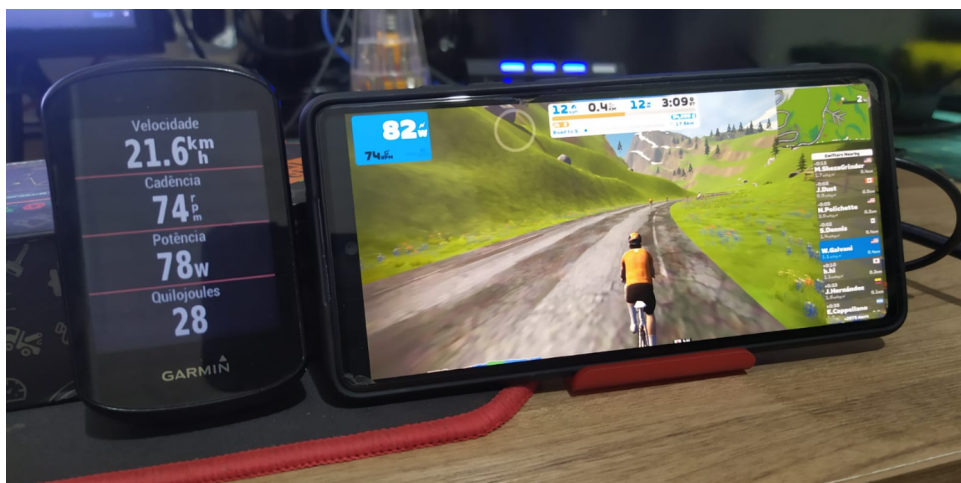
Figura 39 – Comparação de potência do sensor Fávero Assioma com o do rolo de treinamento.
