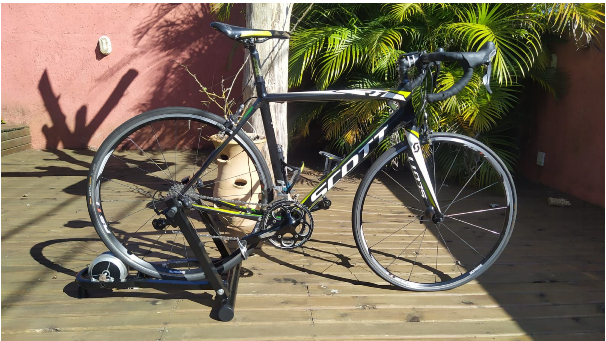
Figura 25 – Rolo de treinamento construído com bicicleta acoplada.
