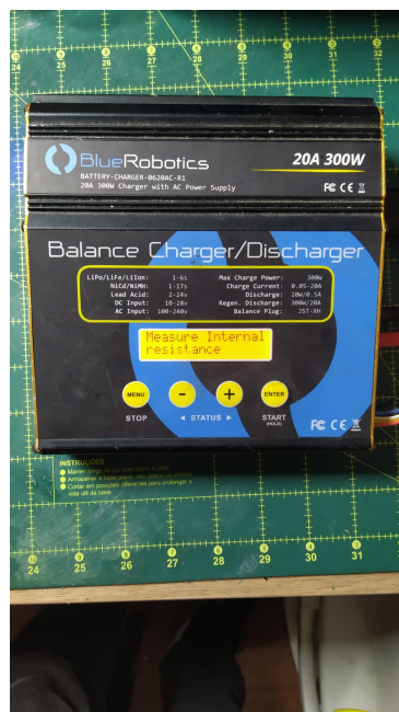
Figura 22 – Equipamento responsável por balancear, carregar e medir a resistência interna das células.
