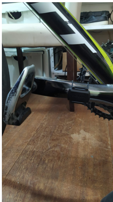
Figura 31 – Sensor de cadência da Magene instalado na bicicleta.
