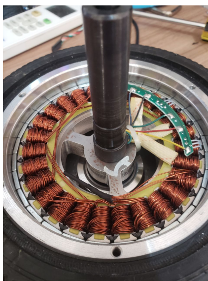
Figura 15 – Motor aberto para identificação da quantidade de polos.
