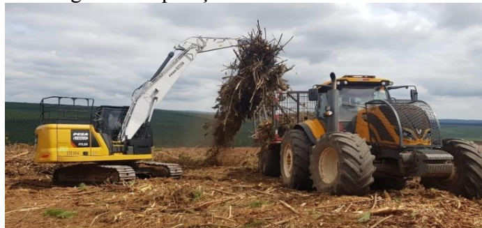
Figura 4 - Operação de baldeio de resíduos.
