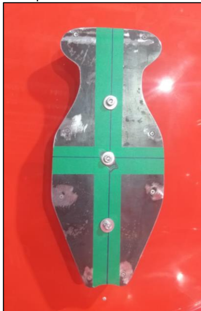
Figura 36 - Apêndice alinhado e fixado no molde
