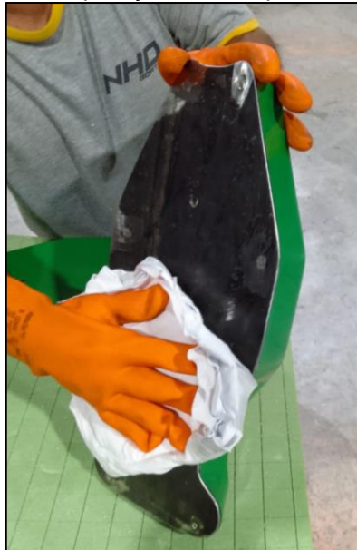
Figura 35 - Aplicação de cera para desmolde
