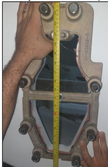
Figura 44 - Validação da altura do espelho de popa
