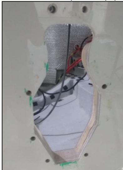
Figura 23 - Corte realizado no espelho de popa - vista externa
