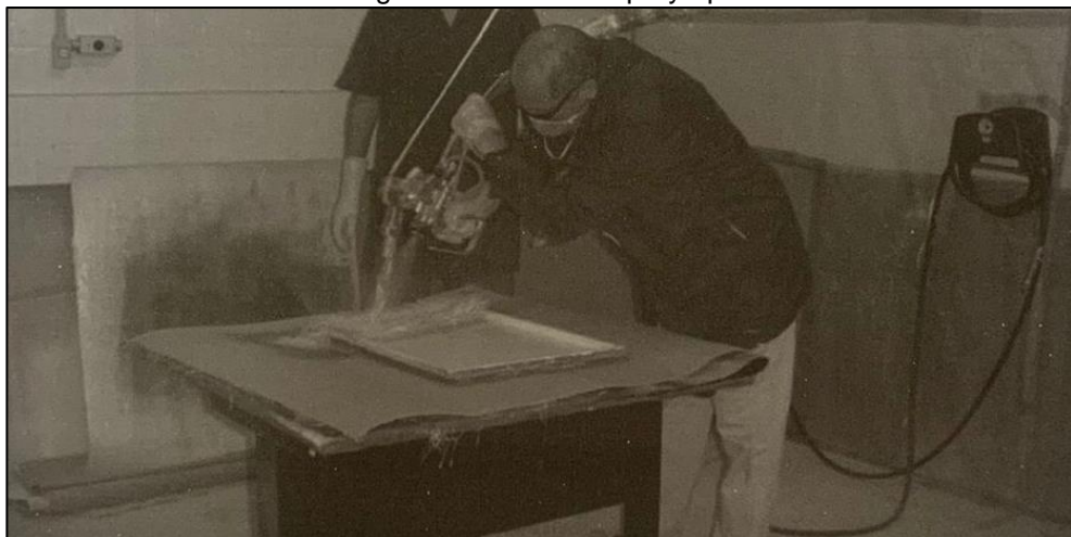
Figura 8 - Processo spray up
