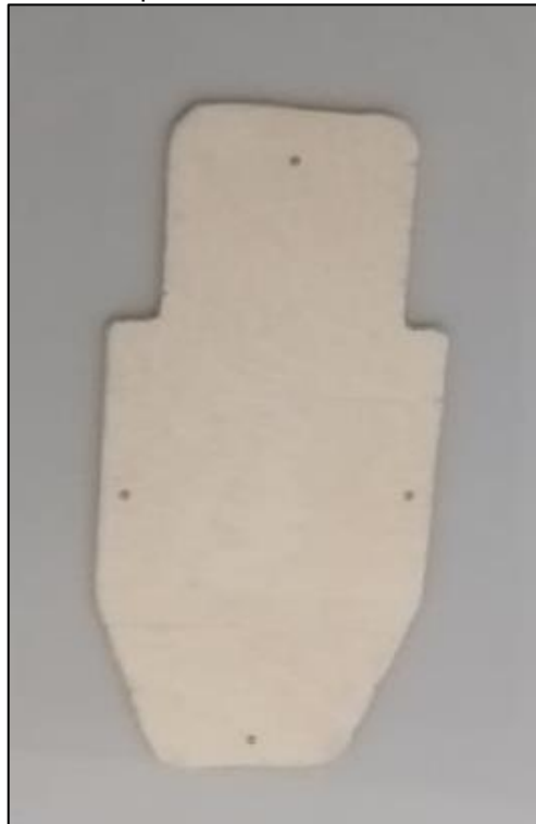
Figura 25 - Isolamento superfície externa do recorte do espelho de popa
