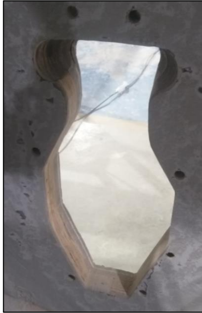
Figura 24 - Corte realizado no espelho de popa - vista interna
