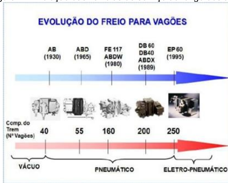
Figura 7 - Evolução das válvulas de serviço ao longo dos anos
