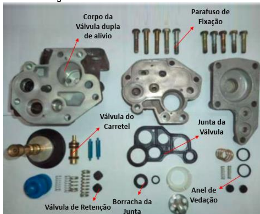
Figura 11 - Válvula ABDX internamente
