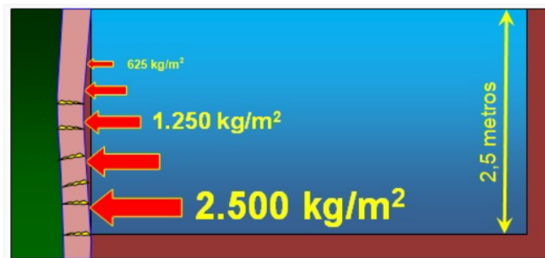
Figura 13 – Processo de fissuração por pressão hidrostática excessiva
