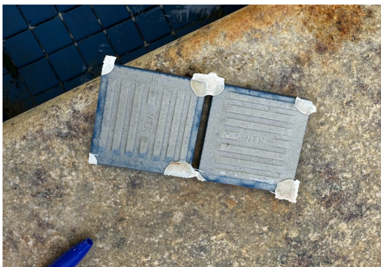
Figura 43 – Pastilhas cerâmicas deslocadas
