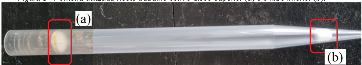
Figura 5 - Ponteira utilizada neste trabalho com o disco superior (a) e o filtro inferior (b).
