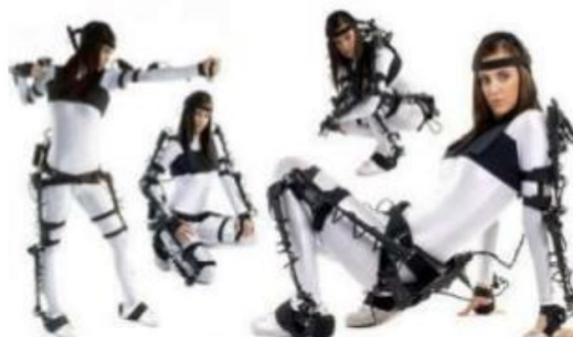
Figura 7- Exoesqueleto do sistema mecânico de captura de movimentos
