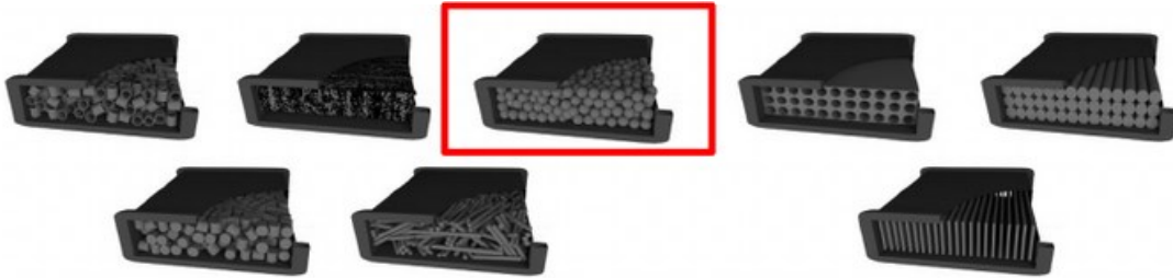
Figura 6 – Diferentes geometrias de RMA. Destacado pelo retângulo vermelho o empacotamento de partículas.
