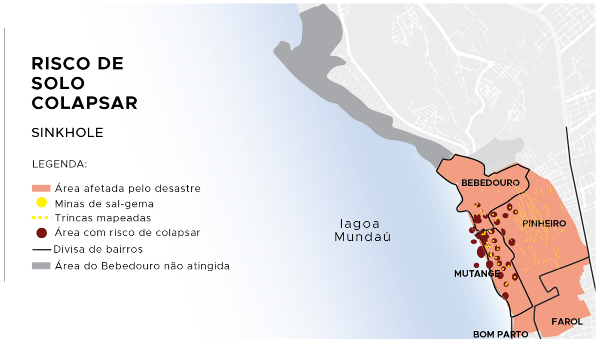
Figura 16: Mapa da área comprometida, com indicação das minas de sal-gema, trincas mapeadas e área de sinkhole .
