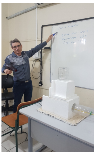
Figura 4.19 - Colocando calor na entrada do CE com o secador
