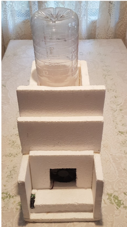
Figura A.27 - Foto da parte de trás do CE, por onde entra o ar quente e seco
