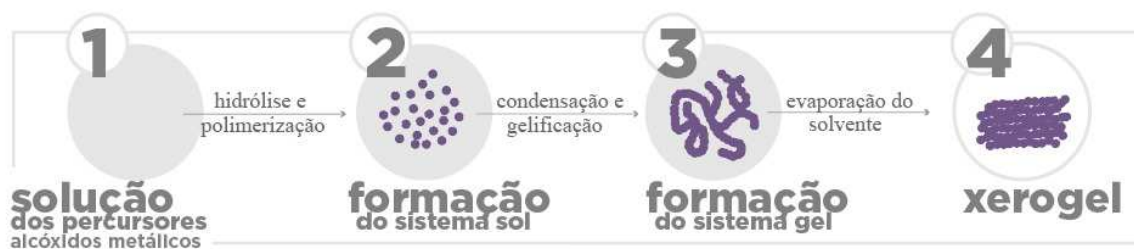
Figura 2 Representação do processo sol-gel para formação de xerogéis.
